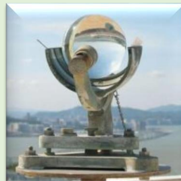
Figura Nr.34. – Pamje e instrumentit të heliografit, që shërben për regjistrimin e orëve me diell.
